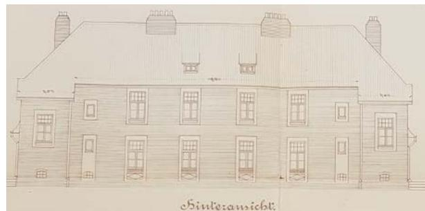
Abb. 102 Ursprünglich nur kleine Schleppdachgauben zur Belichtung des Dachbodens (Beispiel rückwärtige Dachfläche des Haustyps C)
